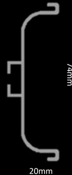
Perfil para la parte central del mueble, evitando usar jaladeras en puertas o cajones. Generando homogeneidad en el diseño.
